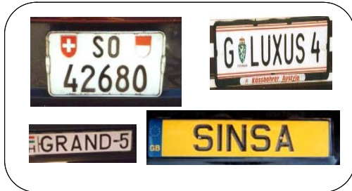
Abb. 11: Videomaut: Fahrzeugkontrollschild anstelle von Erfassungsgeräten
